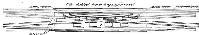
Bild 126. Dubbelspetsad korsning med spetsar och vingrälsinlägg av manganstål för dubbel korsningsväxel.
