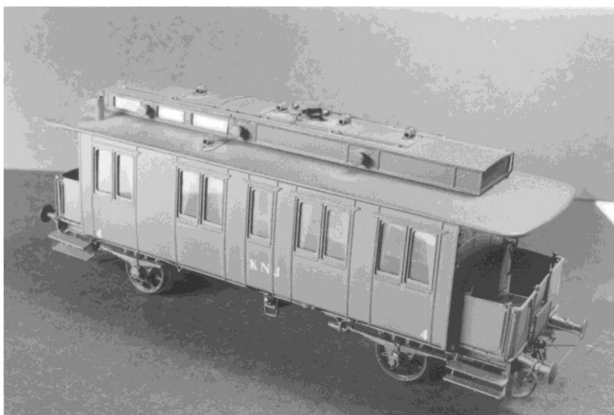
Figur 1 Vagn nr 4 från Krylbo-Norbergs Järnväg, fd DHdJ och SJ. AGA-belysningen är en rekonstruktion baserad på foton och produktkataloger.
