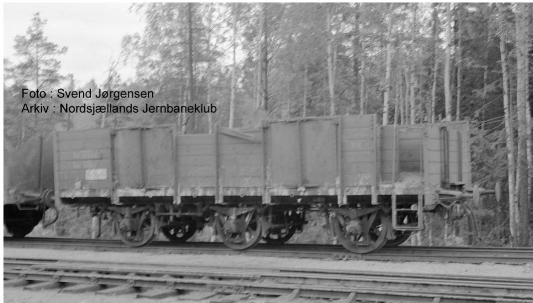
Figur 1. SJ-märkt f.d. GDJ I3M-vagn med bromsbås och låg gavelläm, visad av Ole M. Nielsen på Järnvägshistoriskt forum 2018-07-26.
